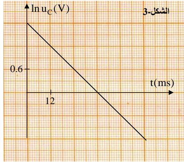
أ- بين أن المعادلة التفاضلية التي يحققها التوتر الكهربائي  $u_C$  بين طرفي المكثفة تعطى بالشكل :
